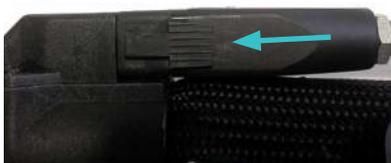
2. Colocar el protector térmico para la unión hidráulica manguera-aplicador.
