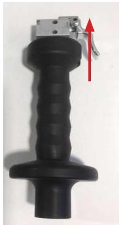
5- Cambiar el gatillo y hacer el proceso inverso para montar el aplicador.
