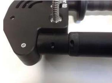
4. Conectar eléctricamente el conector macho del aplicador con el conector hembra de la manguera.
