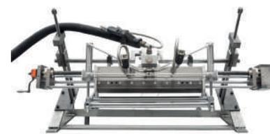
Testina de 350 mm con rulli di pressione del substrato. Sistema d'integrazione (supporto e cilindri).
