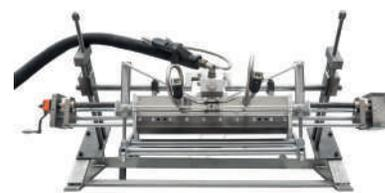
Applicateur de 350 mm avec rouleaux tendeurs de pression de substrat et son propre système d'intégration (supports et vérins)
