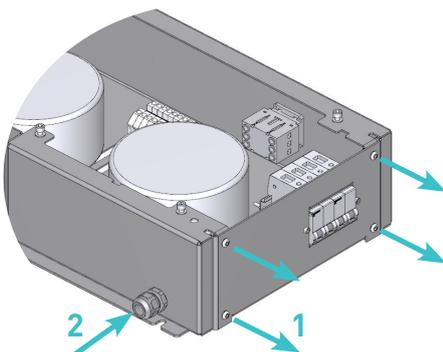
3. Conectar los tres cables de fase en sus bornes correspondientes del magnetotérmico indicado. Igualmente fijar el cable de tierra en su ubicación.
