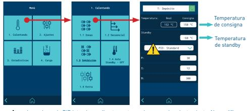
Los valores de PID intervienen directamente en el proceso de calentamiento. No modificar estos valores si no se dispone del conocimiento técnico necesario o sin el asesoramiento del Servicio Técnico de Focke Meler.
